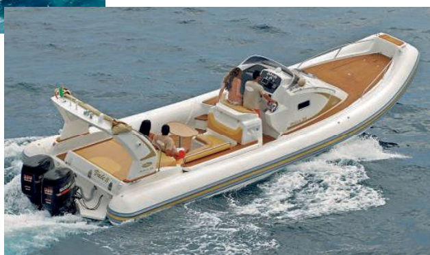
Figura 7 – Imbarcazione entro-fuori bordo con bracket bimotore
