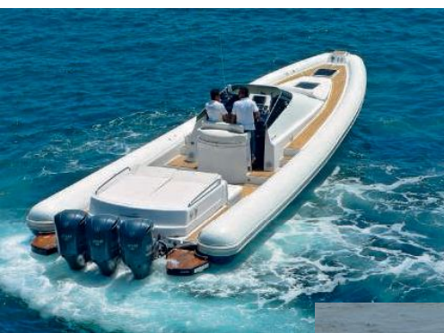
Figura 6 – Imbarcazione entro-fuori bordo con bracket tre motori per 1.050 HP
